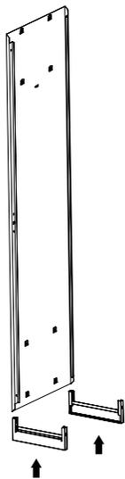
Схема №1: К боковине (поз.1) снизу присоединяем два швеллера (поз.2);
